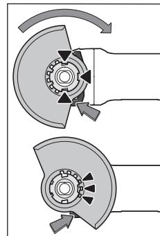
Așezați capacul de protecție (7) pe sistemul de prindere al sculei electrice, potrivindu-l până când camele de codificare ale apărătoarei de protecție se suprapun pe sistemul de prindere. Apăsați și țineți apăsată în acest timp pârghia de deblocare (1). Apăsați capacul de protecție (7) pe gulerul axului până când colierul capacului de protecție este fixat de flanșa sculei
