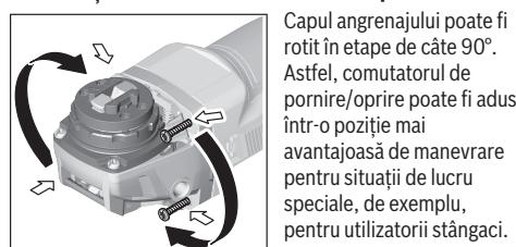
Capul angrenajului poate fi rotit în etape de căte 90°. Astfel, comutatorul de pornire/oprire poate fi adus într-o poziție mai avantajoasă de manevrare pentru situații de lucru speciale, de exemplu, pentru utilizatori stângaci. Deșurubați complet cele 4
