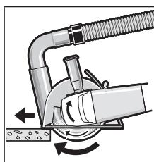
Porniți scula electrică și aşezați-o cu partea frontală a saniei de ghidare pe piesa de lucru. Împingeți scula electrică cu avans moderat, adaptat la materialul de prelucrat.
