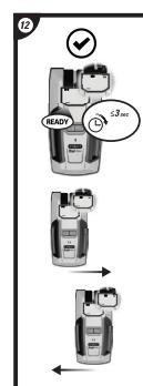
Avec l'icône « METAL SCAN » ou « AC SCAN » allumée, tenez fermement le Détecteur de Montant 300 à plat contre la surface.
