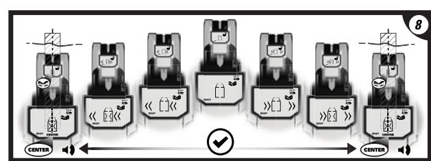
6/7 Ko bo senzor zaznal sredino nosilca, se bo na LCD zaslonu prikazala ikona "Center (Sredina)" senzor pa bo oddal zvočni signal. Za označitev sredine nosilca uporabite kanal za označevanje, ki je na zgornjem delu senzorja nosilcev.
