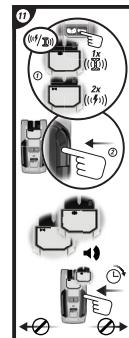
När "METAL SCAN" eller "AC SCAN"-symbolen lyser, håll Stud Sensor 300 plant mot ytan så att en stabil kontakt uppnås.
