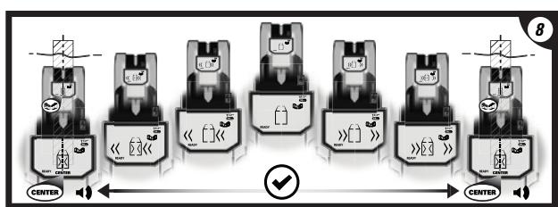
6 / 7 Όταν εντοπίσει το μέσο του ορθοστάτη, στην οθόνη LCD θα εμφανιστεί το εικονίδιο "CENTER" (Μέσον) και θα παραχθεί ένα ηχητικό σήμα. Χρησιμοποιήστε το κανάλι σήμανσης που βρίσκεται στο πάνω μέρος της μονάδας για να μαρκάρετε το μέσο του ορθοστάτη.
