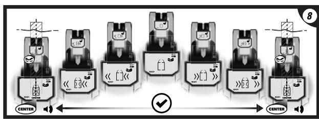
6 / 7 Când se detectează centrul montantului, pictograma „Center” (Centru) va apărea pe LCD și va fi emis un ton sonor. Folosiți de canalul de marcări aflat în partea din sus a unității pentru a marca centrul montantului.
