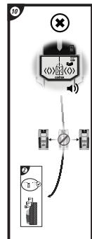
7 Пълзнете сензора за шипове 300 бавно по повърхността по права линия. Както открие шип, уредът ще покаже относителното положение на шипа на екрана.
