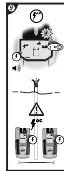
**Nota:** Las cargas eléctricas estáticas que pueden desarrollarse en las paredes internas y otras superficies extenderán el área de detección de voltaje varias pulgadas hacia ambos lados del cable de electricidad real. Para ayudar a localizar la posición del cable, explore manteniendo la unidad alejada ½" de la superficie de la pared o coloque la otra mano en la superficie a aproximadamente 12" del sensor.
