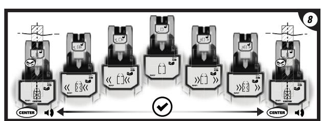
8 / 7 När den upptäcker regelnas centrum kommer "Center"-symbolen att visas på LCD-skärmen och en ljudsignal hörs. Använd markeringskanalen längst upp på enheten för att markera regelnas centrum.
