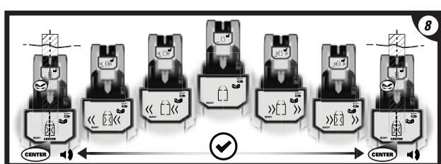
8 / 9 Когато открие центъра на шипа, на течноокристалния дисплей се появява иконата „Center“ („Центръ“) и зазвучава звуков сигнал. Използвайте маркирането на канал, което се намира в горната част на уреда за отбележване на центъра на шипа.
