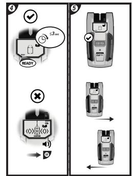
6 Om alla segment på LCD:n blinkar när aktiveringsknappen trycks in, flytta då Stud Sensor 300 till en annan plats och försök igen. När aktiveringsknappen släpps, stängs sensorn av.
