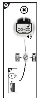
⑩ Je-li aktivační tlačítko stisknuto a začnou-li všechny segmenty na LCD displeji blikat, přesuňte detektor Stud Sensor 300 na jiné místo a pokuste se o kalibraci znova. Uvolnění aktivačního tlačítka způsobí vypnutí snímače.
