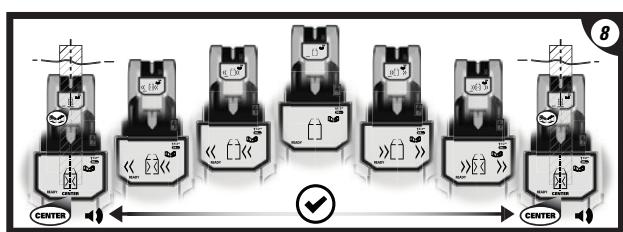
⑥ / ⑦ Lorsqu'il détecte le centre du montant, l'icône « Center » apparaît sur l'écran LCD et un son est émis. Utilisez le canal de marquage au sommet de l'appareil pour marquer le centre du montant sur le mur.
