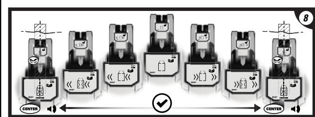
⑥ / ⑦ Jakmile bude detekován střed sloupu, na LCD displeji se objeví ikonka „Center“ (Střed) a bude znít zvukový signál. Použijte pro vyznačení středu sloupu značkovací rysku nacházející se na horní části detektoru.
