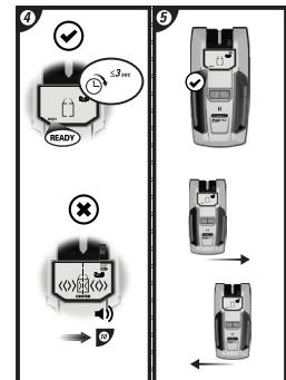
10 Če ob pritisku gumba za aktivacijo vsi segmenti na LCD zaslonu zasvetijo, ob sprostitvi gumba za aktivacijo pa se izklopijo, premaknite senzor nosilcev 300 na drugo mesto in ponovite postopek. Sprostite gumb za aktivacijo izklopi senzor.
