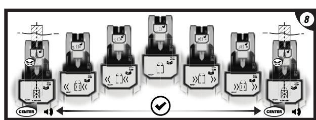
⑥ / ⑦ Dikmenin merkezini algıladığında, LCD ekran üzerinde "Merkez" (Center) simgesi çıkacak ve bir sinyal tonu işitilecektir. Dikmenin merkezini işaretlemek için üniteyi üzerinde bulunan işaretleme kanalını kullanın.
