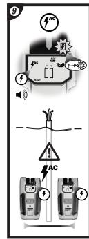
**Napomena:** Statički elektricitet koji se može nakupiti na pregradnom zidu i drugim površinama može raširiti područje detekcije napona mnogo centimetara na svaku stranu stvarne žice pod naponom. Kako biste lakše otkrili položaj žice, skenirajte držeći uređaj 1-1,5 cm od površine zida ili stavite drugu ruku na površinu oko 30 cm od senzora.
