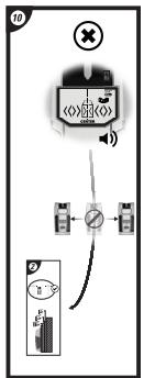
7 Skjut Stud Sensor 300 saktat över ytan i en rak linje. När den upptäcker en regel visar enheten den relativ positionen för bulten på skärmen.
