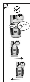
Con el icono "DETECCIÓN DE METALES" o "DETECCIÓN DE CA" iluminado, Ponga el sensor de paralelos 300 en contacto con la superficie, manteniéndolo firmemente apoyado.
