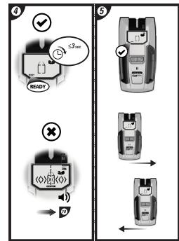
10 Ak sa pri stlačení aktivačného tlačidla všetky segmenty na LCD displeji bliknutím rozsvietia a zhasnú, premiestnite snímač Stud Sensor 300 na iné miesto a skúste to znova. Pustenie aktivačného tlačidla vypne snímač.
