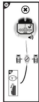
⑩ Aktivasyon düğmesine basıldığında LCD'nin bütün bölümleri yanıp sönerse, Dikme Sensörü 300'ü farklı bir yere hareket ettirin ve tekrar deneyin. Aktivasyon düğmesinin bırakılması sensör kapatacaktır.
