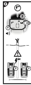
**OBS!** Statiska elektriska laddningar som kan utvecklas på gips och andra ytor kan utöka spänningssdetekteringsområdet med många cm på alla sidor av den faktiska elektriska ledningen. För att underlättा lokalisering av kabelns läge, skanna genom att hålla enheten drygt 1 cm från väggytan eller placera den andra handen på ytan ungefär 30 cm från sensorn.
