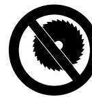
Nu utilizați discuri de fierastrăie circulare, unele din metal dur, utilaje mici, drujbe sau alte unele similare – **pericol de răniri mortale!** Dacă la discurile abrazive debitarea se face uniform, la utilizarea discurilor de fierastrău circular dinții acestuia se pot agăta de material. Acest lucru duce la un mod de tăiere agresiv și poate produce forțe de reacție (recul) ale utilajului necontrolabil, deosebit de periculoase.
