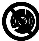
Verificați mai des discul abraziv – înlocuiți-l imediat dacă prezintă fisuri, îndoituri sau alte deteriorări (de ex. supraîncălzire) – prin rupere – **pericol de accident!**
