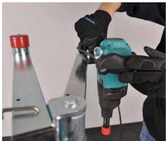
Xo Rührwerk mit den beiden Bohrungen in die Aufnahme hängen
