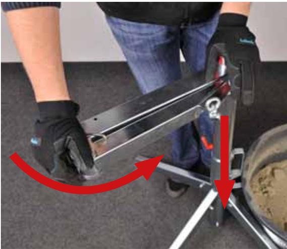
Das Rundrohr gedrückt halten und 4-Kant-Rohr zur Seite schwenken. Ist die Entriegelung gelöst, drückt die Federkraft den Schwenkarm nach oben
