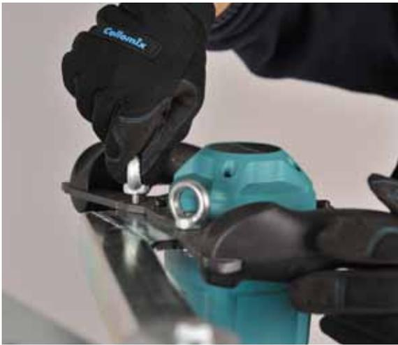
Rührwerk gut festschrauben, bei Bedarf mit einem Steckwerkzeug die Schrauben festziehen.
