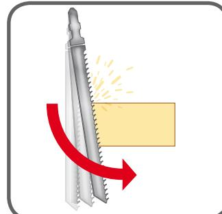
Fonction pendulaire, base inclinable de 0 à 45° et guide parallèle gradué
