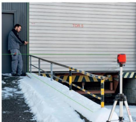
Funcție Impulsuri: Cu receptorul portabil, produsul CROSSLINE poate fi utilizat și în exterior, pentru distanțe de până la 80 m. Ceea ce îl face să fie laserul cu linii în cruce cu raza de acțiune cea mai mare din clasa sa.
